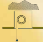
Montaje por la parte superior con el falso techo enrasado al cajón.
