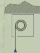
Montaje por la parte superior al forjado
