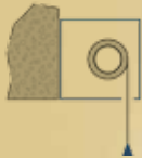
Montaje lateral con caída separada de la pared
