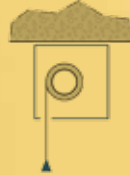
Montaje por la parte superior al forjado
